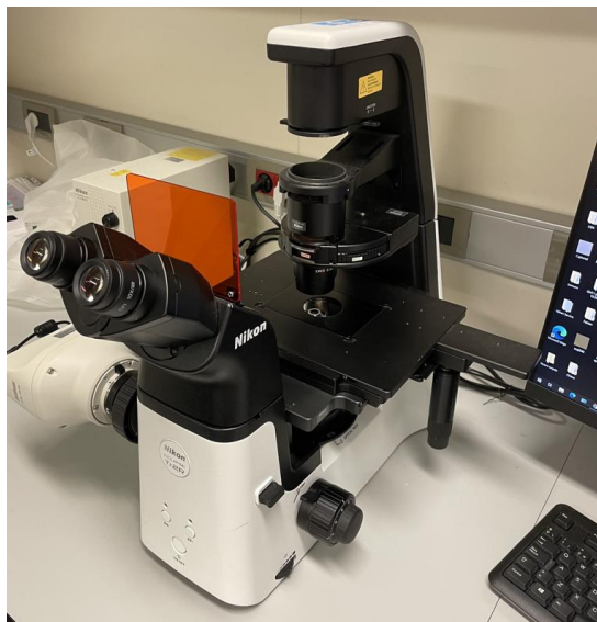
Imatge 14: Microscopi òptic amb contrast de fases utilitzat per inspeccionar cultius cel·lulars.
