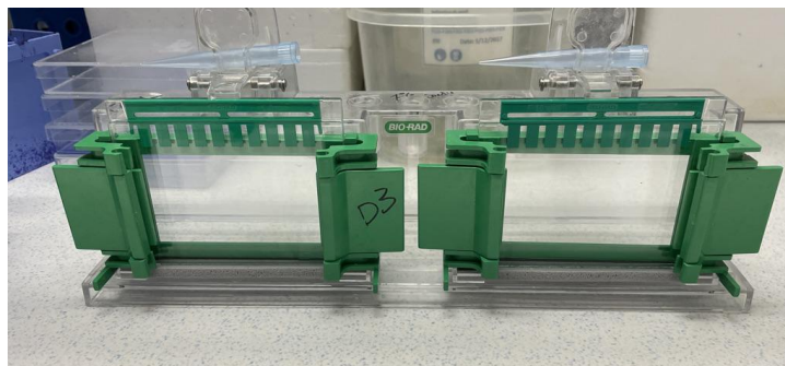
Imatge 15: Aparell de muntatge per a la preparació de dos gels d'acrilamida.
