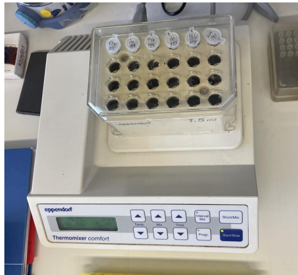
Imatge 18: Escalfament de les mostres a 95°C. Aquest pas es fa abans de fer una centrifugació amb un short spin . L'aparell utilitzat es diu Thermomixer comfort .
