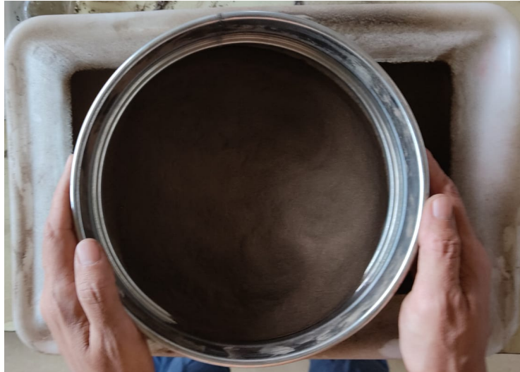
Figura 24: Fotografia del garbell amb una malla de 0,063 mm amb els llims retinguts i les argiles dipositades a la safata.
