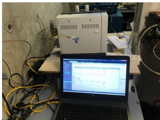
Figura 16. (pròpia) Cromatògraf de gasos a partir d'un gas (micro- GC)
