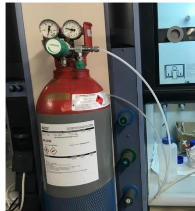
Figura 20. (pròpia) Bombona de gas \text{CO}_2 i \text{H}_2 utilitzada per bombollejar els fermentadors, amb un sistema de vàlvules per a regular la pressió.
