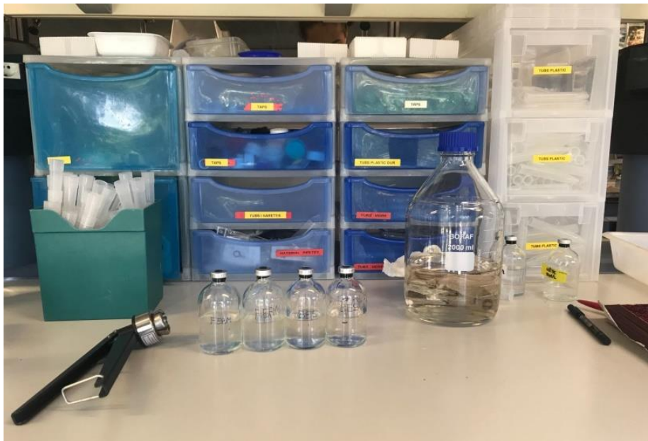
Figura 19. (pròpia) Fermentadors utilitzats durant el procés experimental ordenats pel procediment d'obtenció dels seus inòculs amb les seves respectives rèpliques, juntament amb el capsulador i la solució mare
