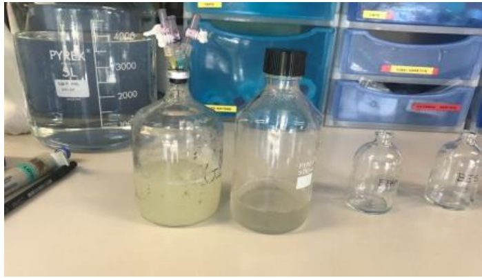
Figura 18. (pròpia) Inòculs obtinguts a partir d'un procés fermentatiu (esquerra) i d'un procés bioelectroquímic
