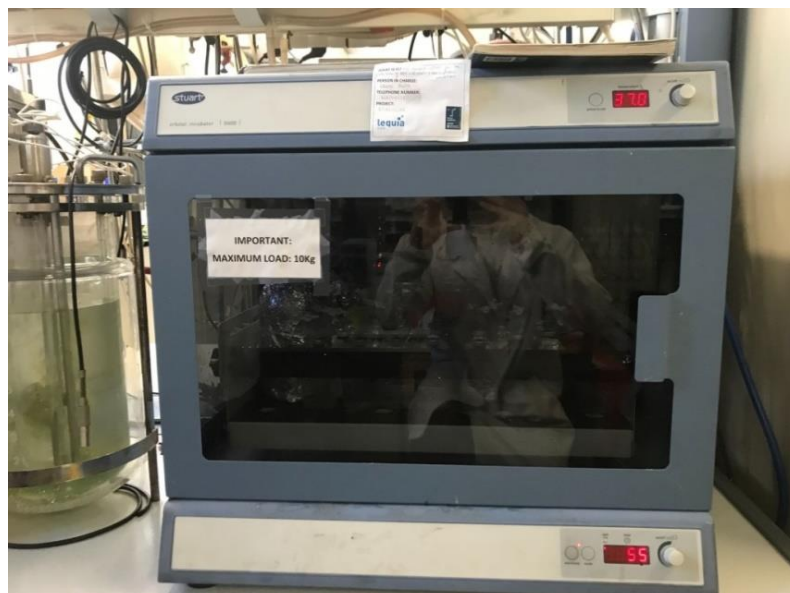
Font 17. (pròpia) Agitador orbital tancat utilitzat per proporcionar les condicions òptimes pel creixement bacterià.
