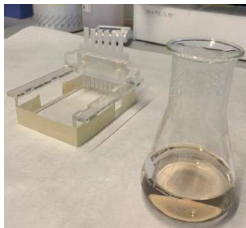
Figura 78 A la derecha está la mezcla de agarosa y tampón. A la izquierda el molde en el que se vierte
