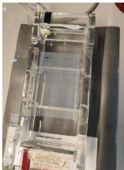
Figura 79 El gel de agarosa sumergido en tampón TBE, dentro de la cubeta de electroforesis
