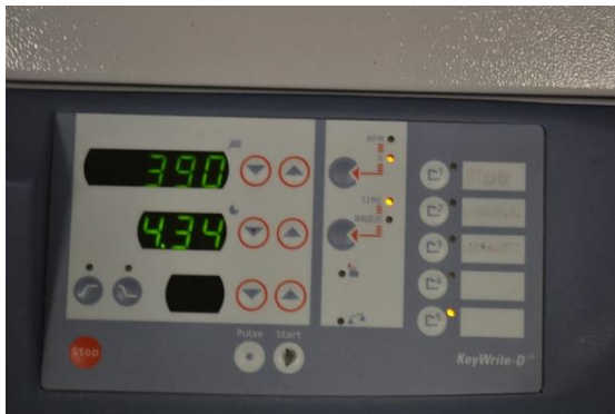
Figura 30: Panell de control centrífuga.
