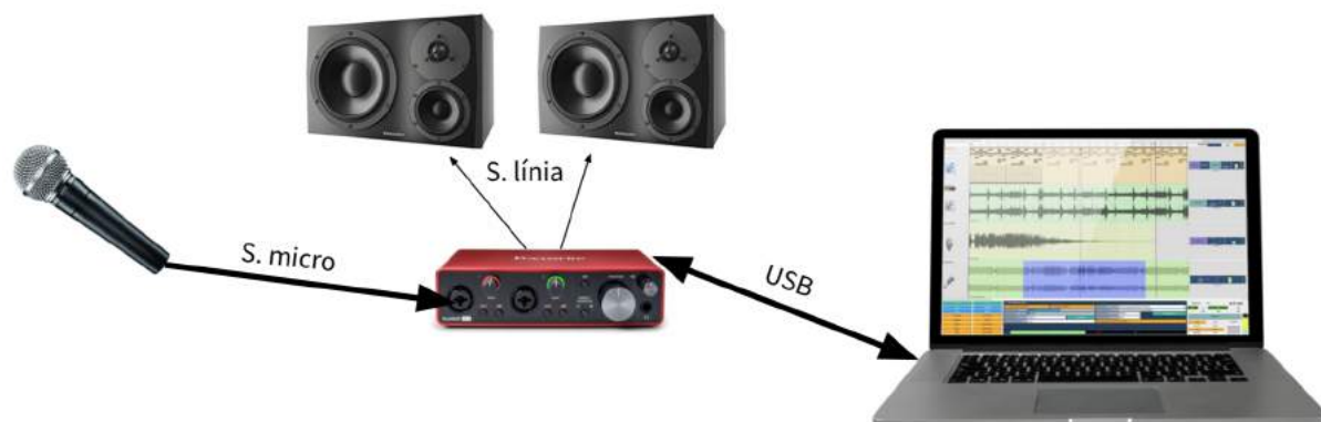
Fig. 58 Esquema bàsic d'un Home Studio: El micròfon es connecta a la targeta de so, que transforma el senyal perquè pugui ser llegit per l'ordinador. Aquest processa el so i el torna a reenviar a la targeta, que el farà arribar als monitors o auriculars i fer el senyal audible. Font: ETECAM
