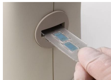
Figura 35: Placa específica del comptador de cèl·lules automatitzat essent inserida a la màquina
