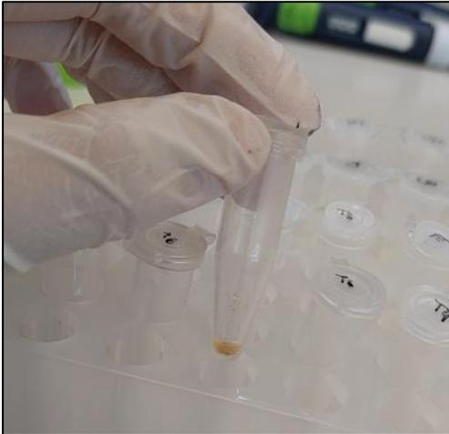
Es necesario cambiar la punta de la pipeta cada vez que se cambie de tubo para evitar la contaminación de cada muestra.
