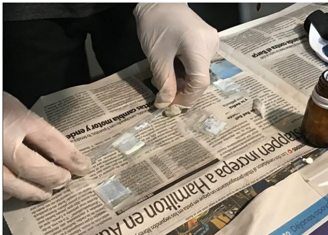
Il·lustració 22. Recobriments dels vidres FTO amb pasta de \text{TiO}_2 usant la tècnica "Doctor blade".
