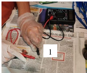
Il·lustració 20. Identificació de la cara conductora.
