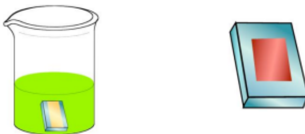
Figura 25. Esquema de impregnació dels substrats amb sensibilitzadors.
