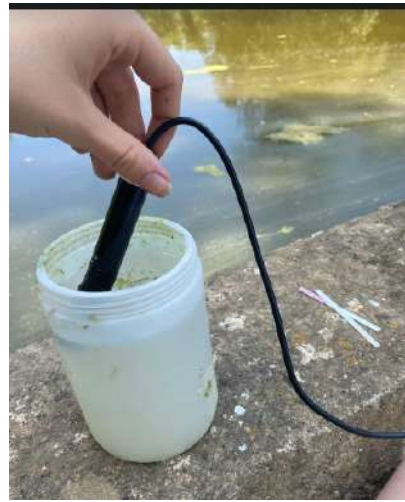
Figura 2: Mesura oxigen Ser, curs baix (Imatge pròpia).
