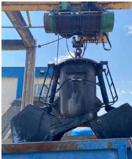
Figura 19: Pinces separadores de sòlids. (Imatge pròpia)
