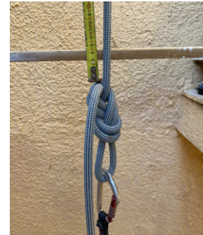
Figura 13. Alargamiento de la cuerda con masa 2kg. [Fuente propia]
