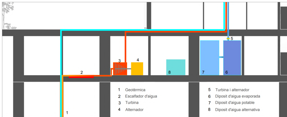
Figura 35. Plànols del funcionament intern de l'edifici en la zona de màquines inferior. Elaboració pròpia.
