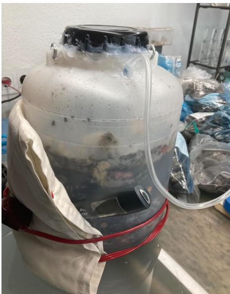
Figura 24: imatge de l'ampolla gasòmetre de 10L amb l'inòcul de bacteris, residus orgànics, manta tèrmica i termòmetre del segon disseny. Font: pròpia.
