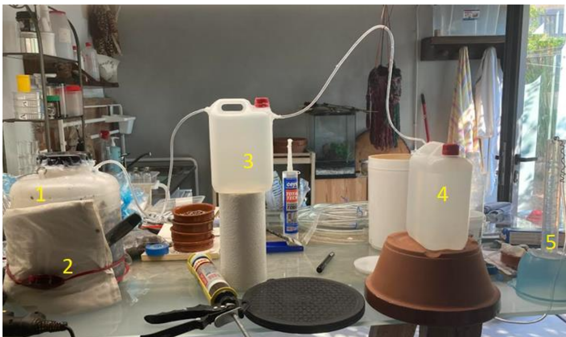
Figura 25: Muntatge complet del segon disseny. 1: Ampolla gasòmetre; 2: Manta tèrmica; 3: Ampolla tampó per evitar retorns al reactor; 4: Sistema de desplaçament líquid; 5: Proveta. Font: pròpia.
