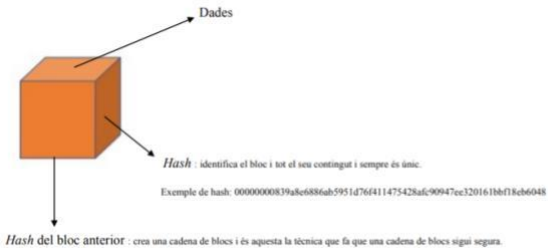
Imatge 12. Parts d'un bloc
