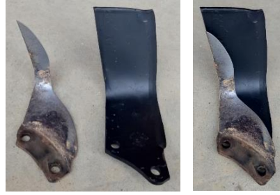
Fig. 3 i 4. Comparativa entre una pala original de l'eina i una de nova.
