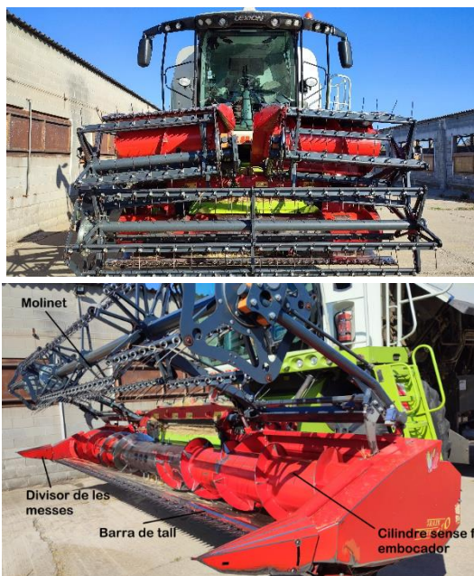
Fig. 1. Capçal d'una recol·lectora Claas, des de dues vistes diferents i amb el molinet plegat. Font pròpia
