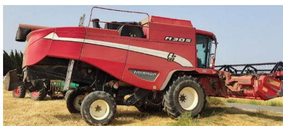
Fig.31. Recol·lectora emprada: model M305 de la marca Laverda
