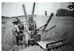
Fig. 3.1. Exemple dels models més populars de McCormick, capaços de segar 4 ha en un dia (la feina equivalent a 5 jornalers) Font: curiosfera-historia.com
