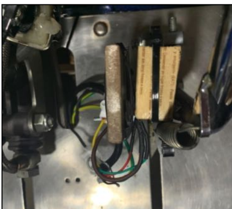
Accelerador, sensor d'efecte hall 49e Col·lecció: Propia
