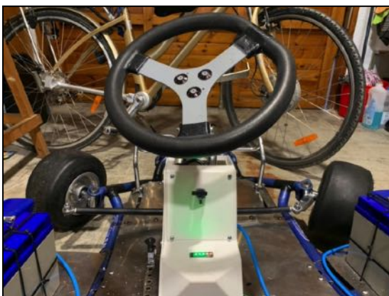
Caixa 3D amb el controlador en el kart Col·lecció: Pròpia
