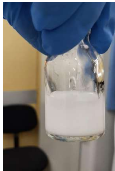
Figura 26. Vial amb les nanopartícules del grup control just després de la segona emulsió.
