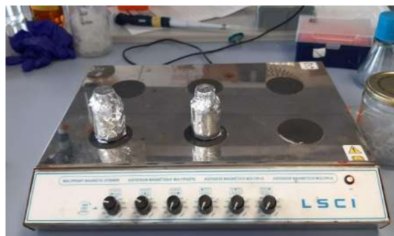
Figura 28. Vials amb les nanopartícules sobre l'agitador embolicats amb paper d'alumini.
