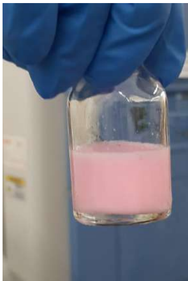
Figura 25. Vial amb les nanopartícules amb Rodamina just després de la segona emulsió.
