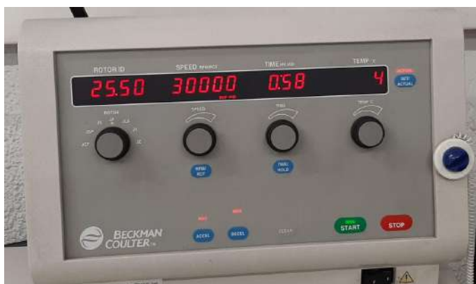
Figura 30. Paràmetres aplicats a la centrifugadora, com podem observar: una força de 30.000 G, durant 60 minuts i a 4°C.
