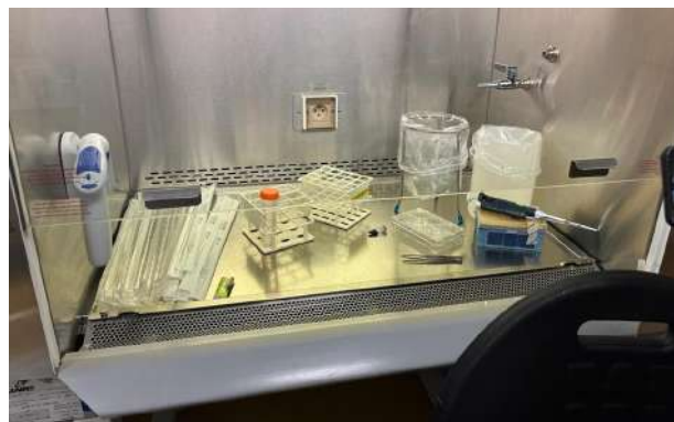
Figura 15. Cabina de bioseguretat preparada amb les pipetes, les pinces i el pipetejador esterilitzats.
