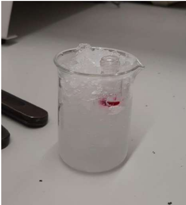
Figura 23. Vas de precipitats amb gel i les fases W1 i O1 de la mostra amb Rodamina en un vial a punt per ser sonicades.
