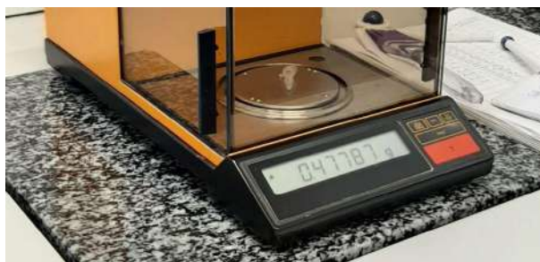
Figura 31. Bàscula analítica pesant un tub Eppendorf buit.
