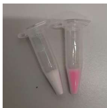
Figura 33. Tubs Eppendorf amb les nanopartícules liofilitzades. A l'esquerra les del grup control i a la dreta les que contenen Rodamina.
