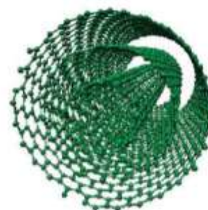
Figura 10. Il·lustració d'un nanotub de carboni de 3 parets. (Font: HIRSCHMANN, T.)
