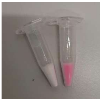
Figura 47. Tubs Eppendorf amb les nanopartícules liofilitzades. A l'esquerra les del grup control i a la dreta les que contenen Rodamina.
