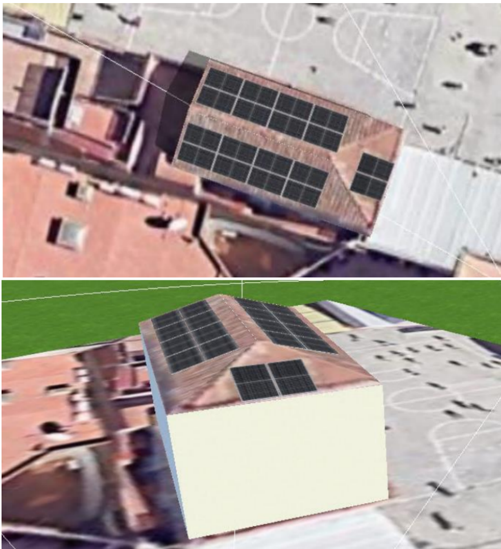
Imatge 33. Simulació 3D col·locació plaques solars edifici ESO
