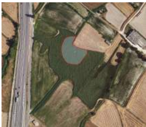
Figura 13. Zona més sensible a les inundacions. Acumulacions puntuals de fins a 0,9 m d'aigua. [Instamaps ICGC]
