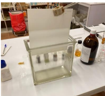
Fig. 18: Extracció de la placa de la cubeta cromatogràfica
