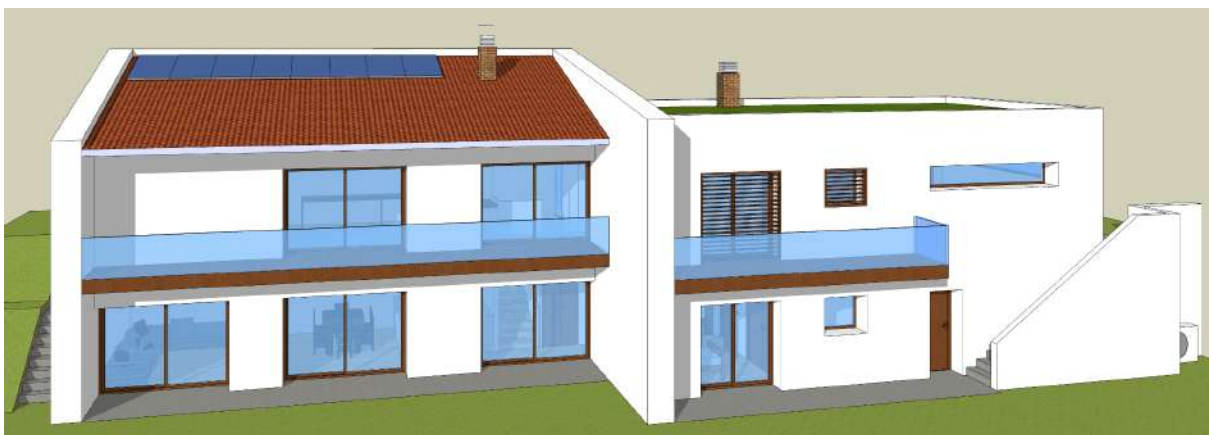
Imatge 101. Incidència solar a la façana sud el 12/21 a les 15:00 hores
