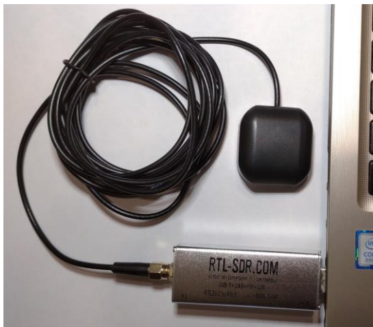
Figura 29: Connexió entre l'antena GPS i el dispositiu SDR amb el port USB de l'ordinador. Imatge pròpia.
