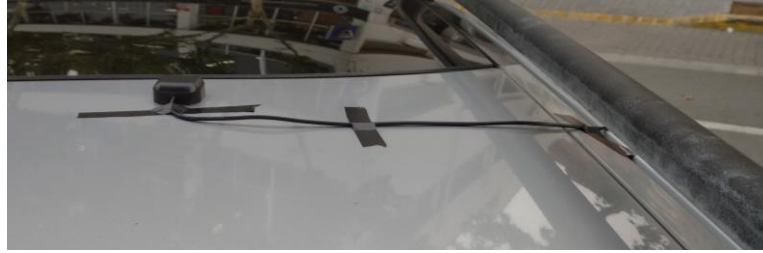
Figura 38: Instal·lació de l'antena al sostre del cotxe, amb l'ajuda del seu imant incorporat i de tires de cinta adhesiva. Es veu com el cablejat baixa pel lateral del vehicle. Imatge pròpia.
