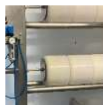
Imatge 19. Premsa horitzontal amb els motlles col·locats i l'èmbol fent pressió
