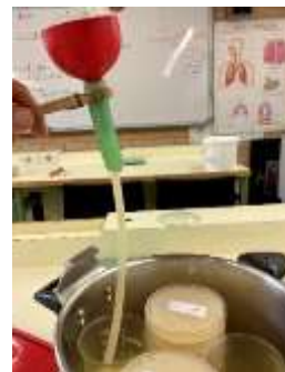
imatge 29. Embut connectat a dos tubs de goma l'extrem d'un dels quals a dins d'un vas de precipitats amb carbonat de calci
