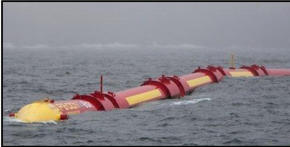
Figura 20. Generador AMD "Snake Pelamis". Font: Encyclopèdia Britànica. Costes d'Escòcia: 28 de març del 2015.
