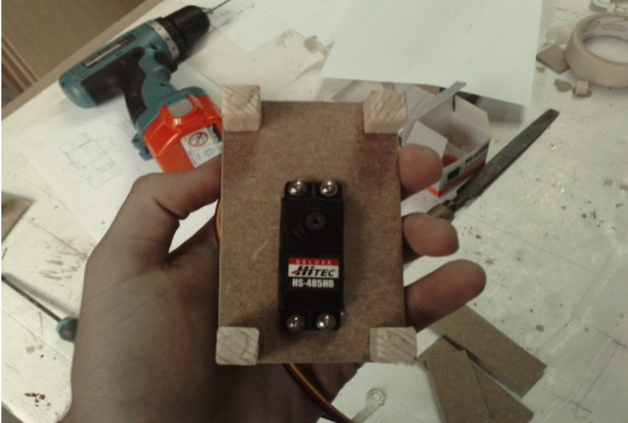
Figura 5. Base braç robot vista per dalt
