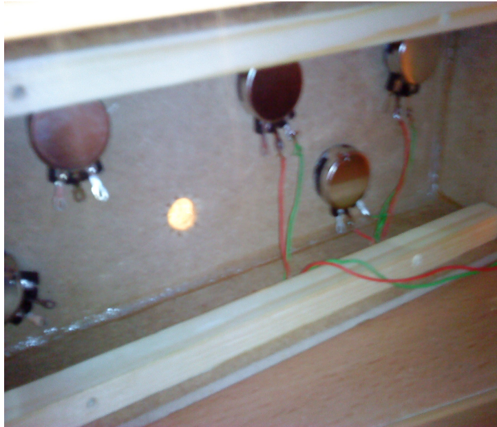
Figura 16. Caixa dels potenciòmetres vista per la part de baix, sense la tapa.
