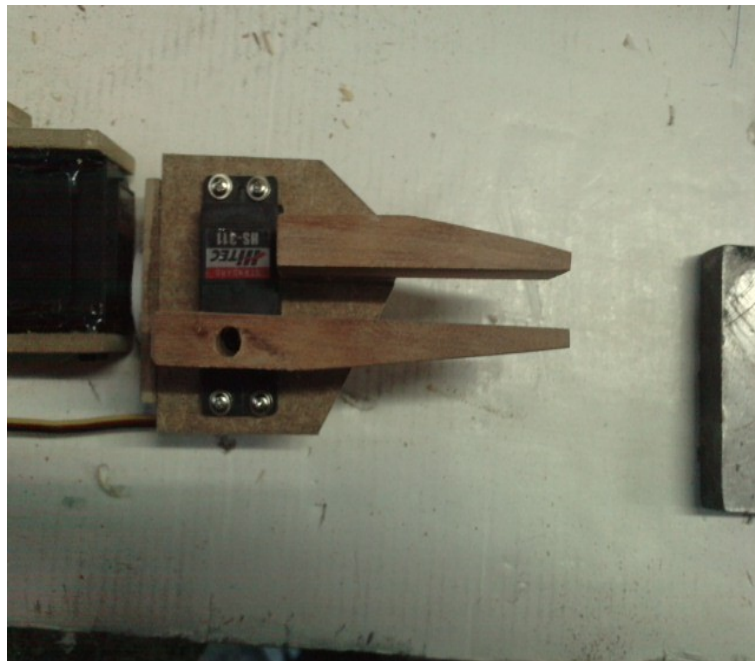
Figura 13. Pinça del braç robot vista des de dalt.
