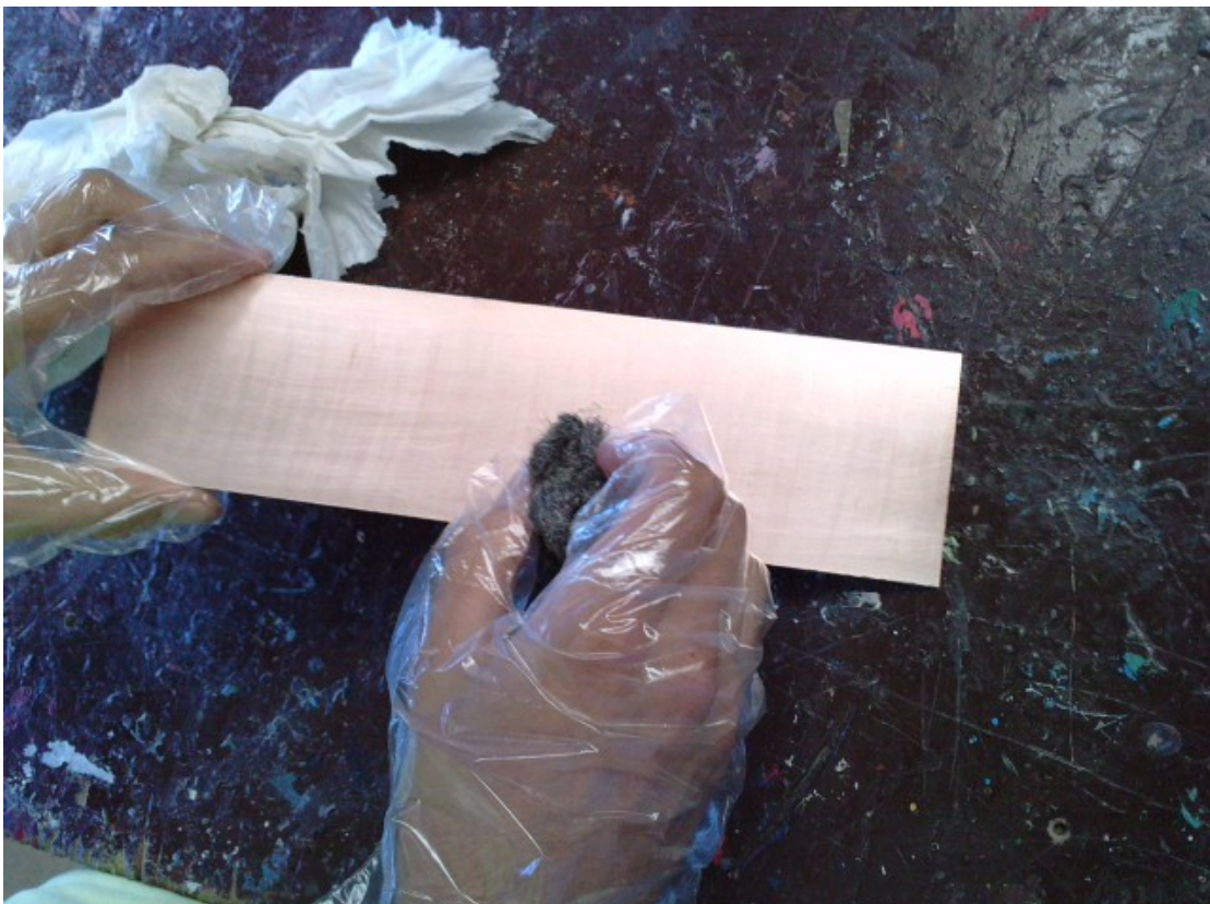
Figura 35. Polint i netejant la placa amb el fragall d'alumini.
