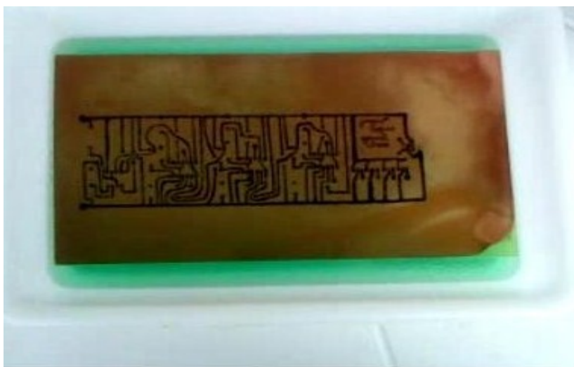
Figura 34. Placa dolenta, al principi de submergir-la en la barreja d'aiguarràs i aigua oxigenada.
