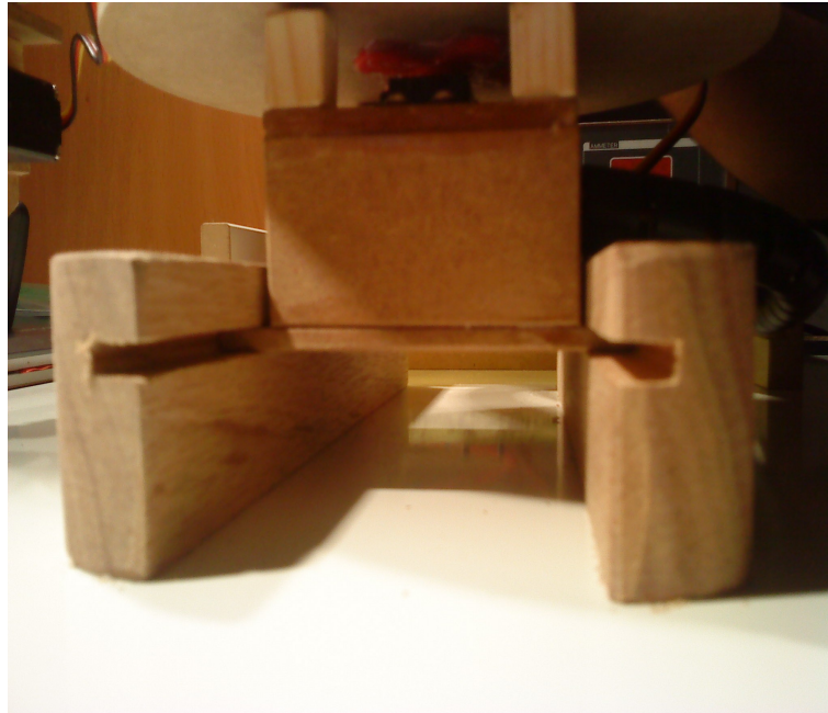
Figura 14. Vista detallada de les guies que subjecten el braç robot.
