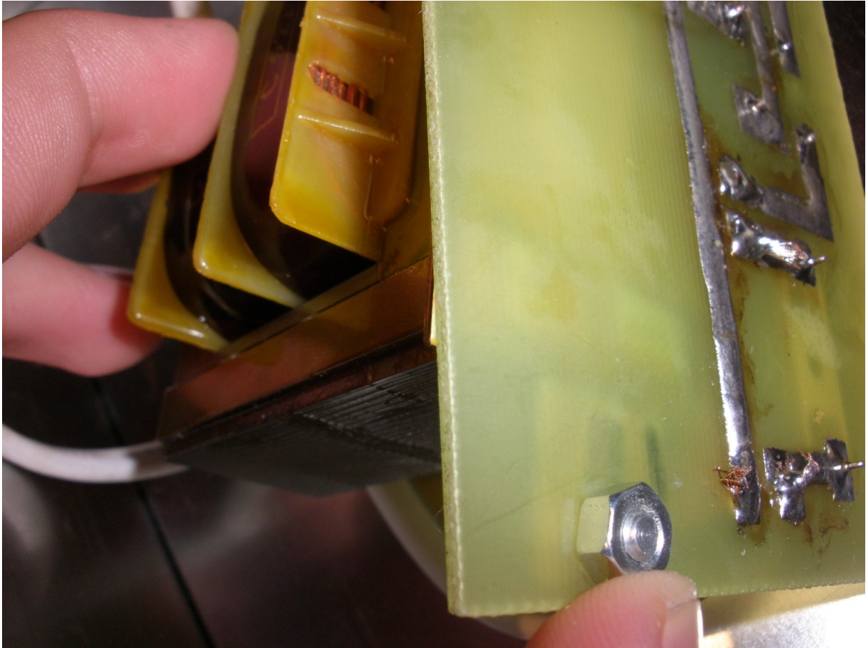
Figura 63. Collant el transformador amb els cargols a la placa.
