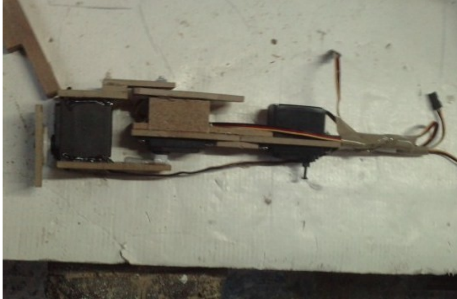
Figura 11. Part superior del braç robot, menys la part de la pinça, que anirà enganxada a l'esquerra de la figura.
