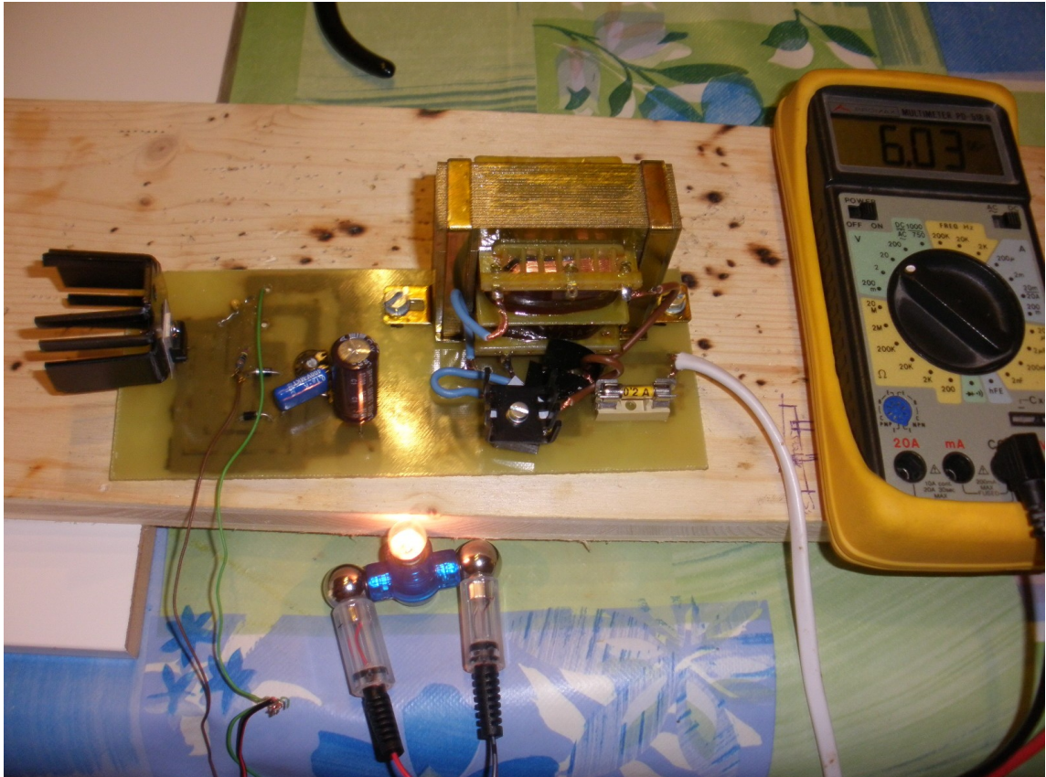
Figura 65. font d'alimentació on fem funcionar una bombeta a 6v.
