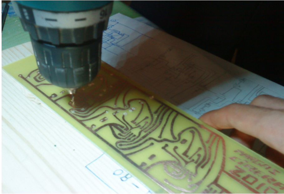
Figura 42. Foradant la placa amb el trepant portàtil.
