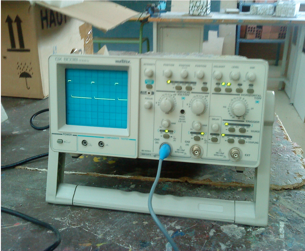
Figura 26. oscil·loscopi ona de 2,5ms
