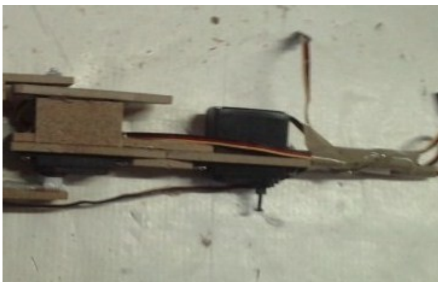
Figura 10. La part de l'esquerra, és la primera part del canell del braç, conté el quart servomotor.
