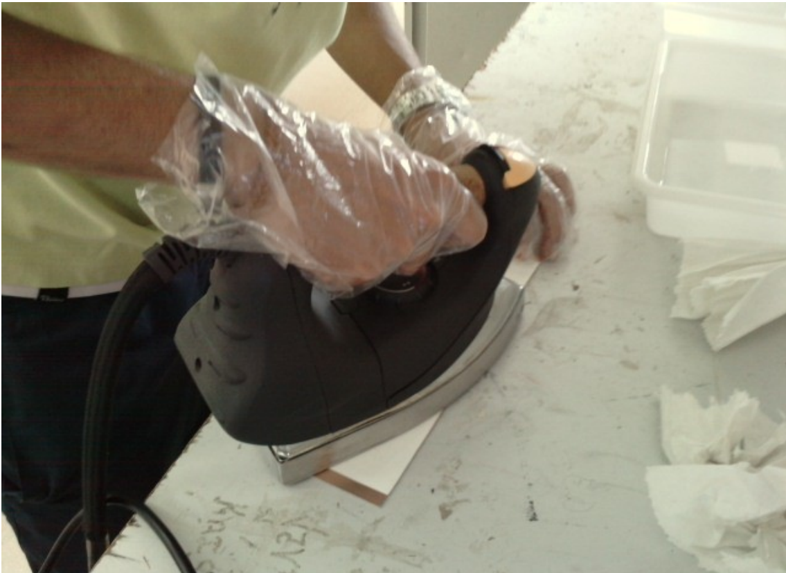
Figura 36. Planxant el circuit imprès a la placa.
