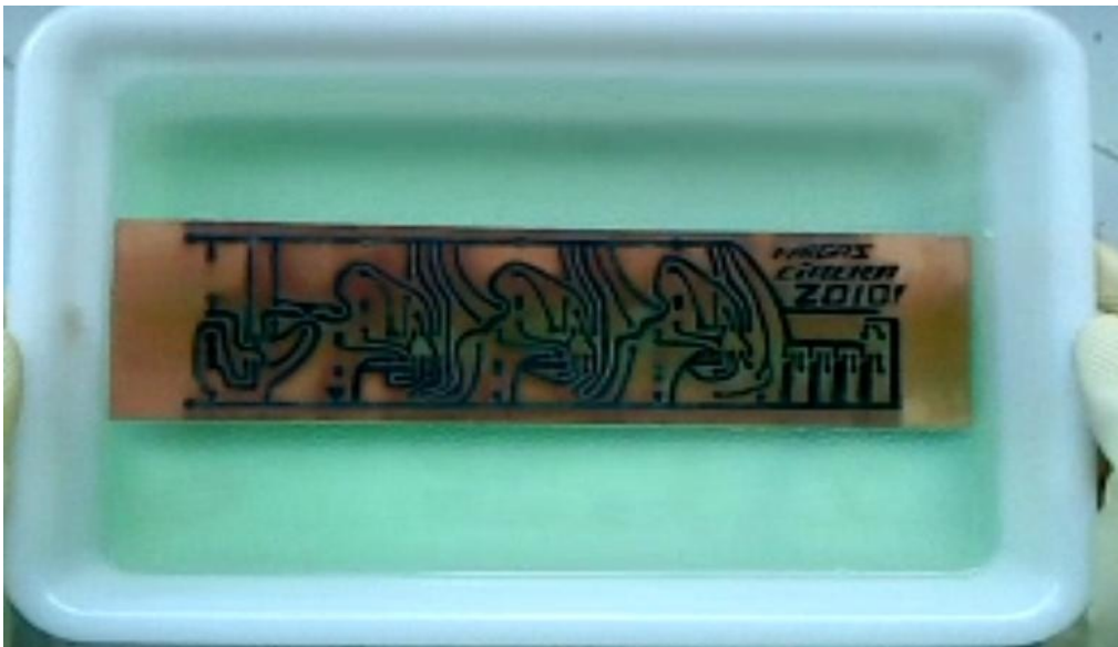
Figura 38. Placa submergida en l'àcid.
