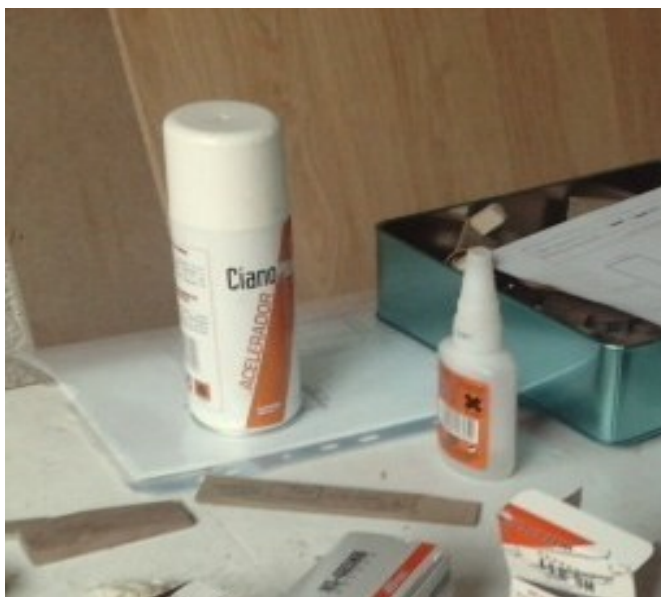
Figura 9. loctite amb catalitzador, a l'esquerra, l'esprai catalitzador i, el pot de la dreta és el pot de loctite.
