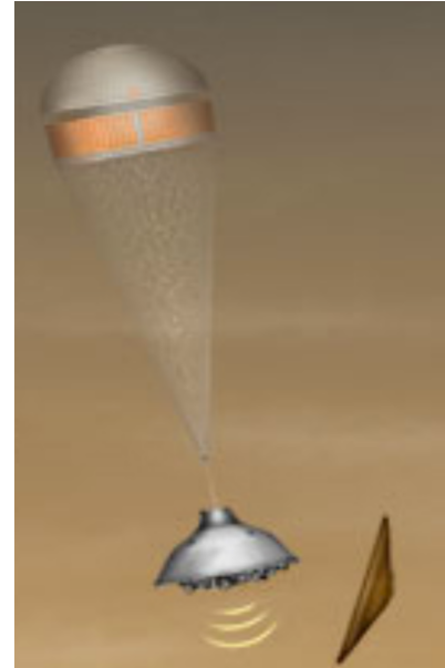
Representació en 3D de l'activació dels radars de la nau. Fotografia extreta de la web: http://mars.jpl.nasa.gov/msl/mission/timeline/
