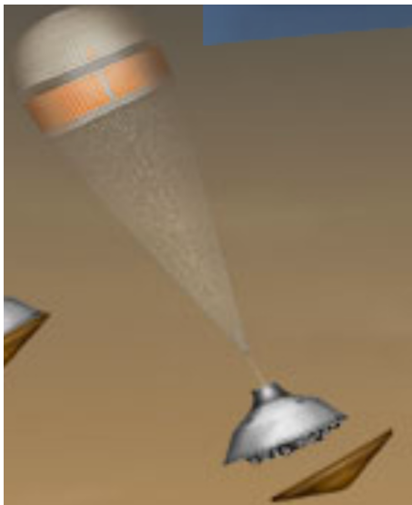
Representació en 3D de la separació de l'escut tèrmic de la nau. Fotografia extreta de la web: http://mars.jpl.nasa.gov/msl/mission/timeline/
