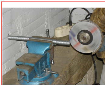
. Il·lustració: Tallant les anelles amb la radial.
