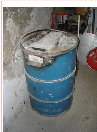
. Il·lustració: El forn de ferro després de més d'una utilització.
