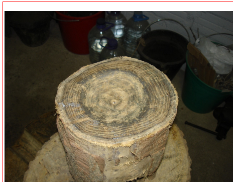
. Il·lustració: Conca de fusta per treballar la xapa.
