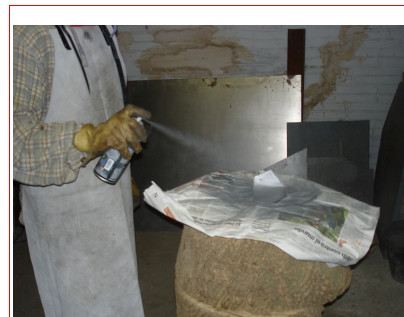
. Il·lustració: Aplicant zinc a l'interior d'una peça.
