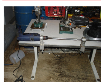
. Il·lustració: Filferro enrotllat en una barra de ferro després d'enrotllar-lo amb un trepant.
