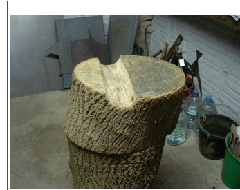
. Il·lustració: Preforma de fusta amb forma de canal i espai per treballar el ferro fred.
