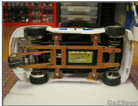
Imatge 1.34: Xassís d'un cotxe del grup A/K (tracció quatre rodes) http://www.gazslot.blogspot.com
