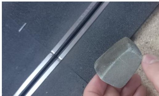
Imatge 1.65: pedra especial per llimar els carrils de les pistes
