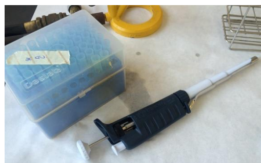
Imatge 15: micropipeta automàtica per realitzar la sembra.
