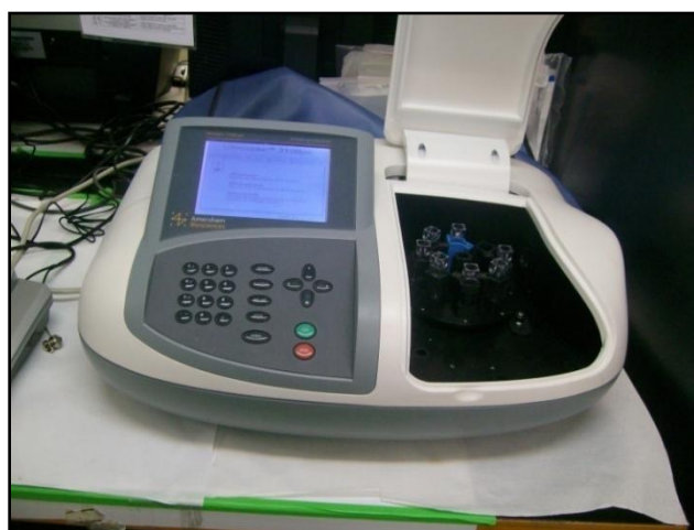
Figura 26. Espectrofotòmetre amb algunes cubetes d'espectrofotometria a l'interior.
