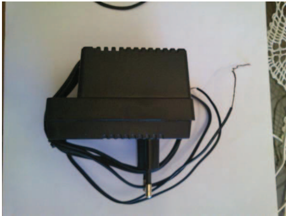
Fig. 11: transformador de 12V
