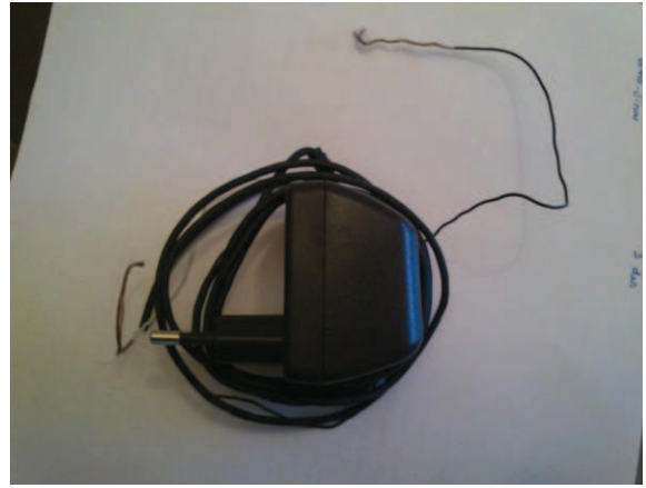
Fig. 12: transformador de 3,7V
