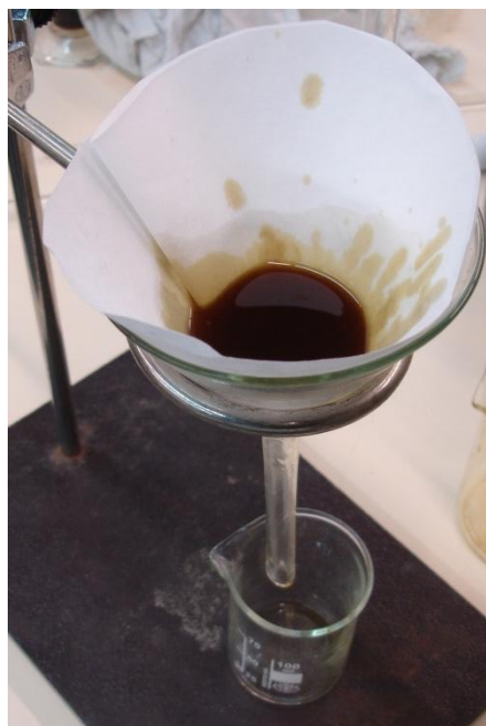
Figura 26. Fotografia de la filtració del producte de la decantació amb sulfat de magnesi anhidre. Font pròpia.
