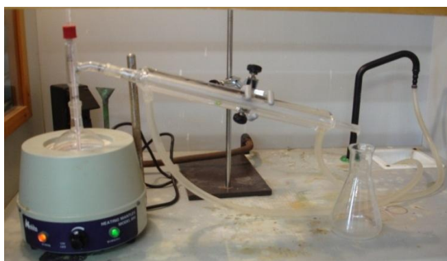
Figura 27. Destil·lació del resultat de la decantació i la filtració per a obtenir la cafeïna i el triclorometà. Font pròpia.
