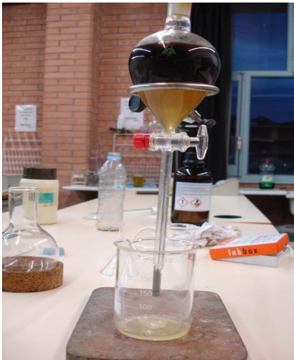
Figura 25. Fotografia de la decantació del cafè amb carbonat sòdic i trilorometà. Font pròpia.
