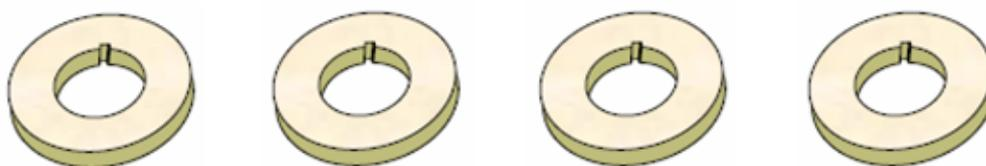
FIGURA 3.29: Anelles de fusta amb un petit rebaix per passar l'abrasadora.
