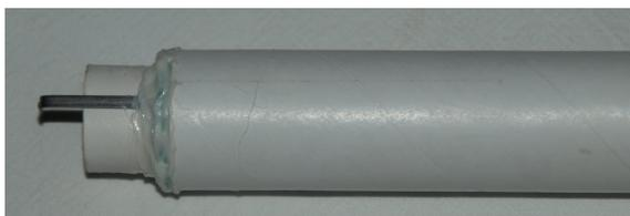
FIGURA 5.21: Suport del motor col·locat reforcat amb silicona al cos del coet.
