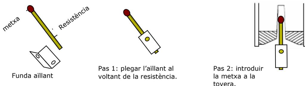
FIGURA 4.9: Introducció d'una espoleta d'una peça.
