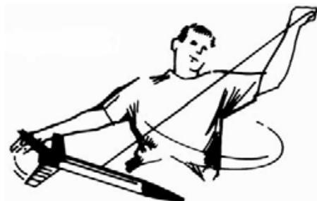
FIGURA 5.34: Model de coet donant voltes sobre si mateix amb una corda lligada al seu centre de gravetat.
