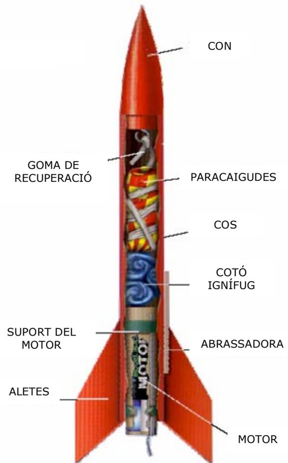
FIGURA 1.7: Model de coet amb les seves parts interiors i exteriors.
