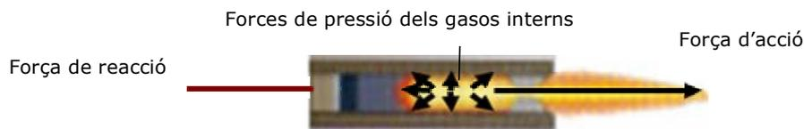
FIGURA 1.24: Exemple de la 3<sup>a</sup> Llei de Newton en relació un motor de coet.
