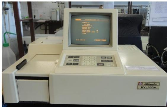
Figura 2: Espectrofotómetro UV-Visible de doble haz
