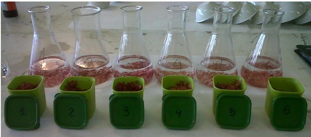
**Figura 12:** Preparación de las muestras de fuet con etanol 40% en sus respectivos Erlenmeyer.
