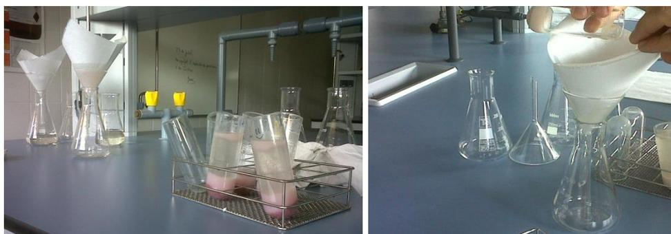
**Figuras 17 y 18:** Filtrado de las muestras de fuet para poder obtener el extracto transparente.
