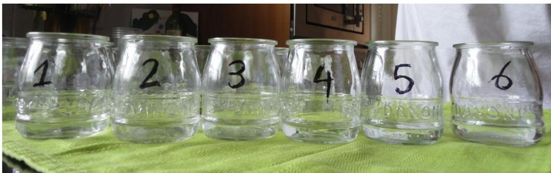
**Figura 7:** Vasos preparados para las muestras con 15 ml de agua destilada.
