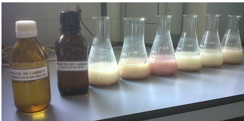
**Figura 14:** Muestras preparadas antes de añadir los 5ml de los dos reactivos Carrez I y II.
