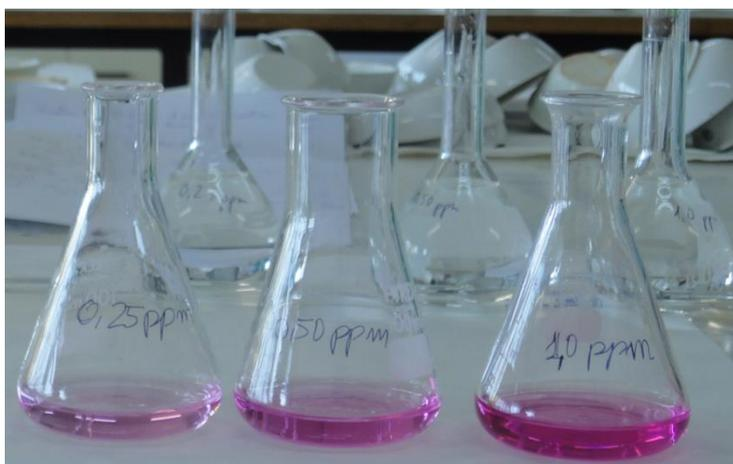
**Figura 10:** Recta patrón preparada para la determinación de nitritos.
