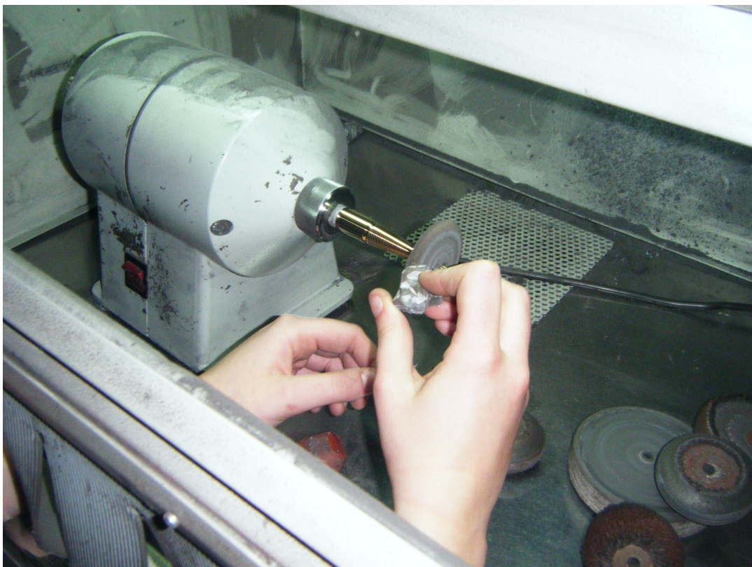
Pas 12: Poso cera a l'esmeril per donar-li a l'anell un polit i acabat final brillant.
