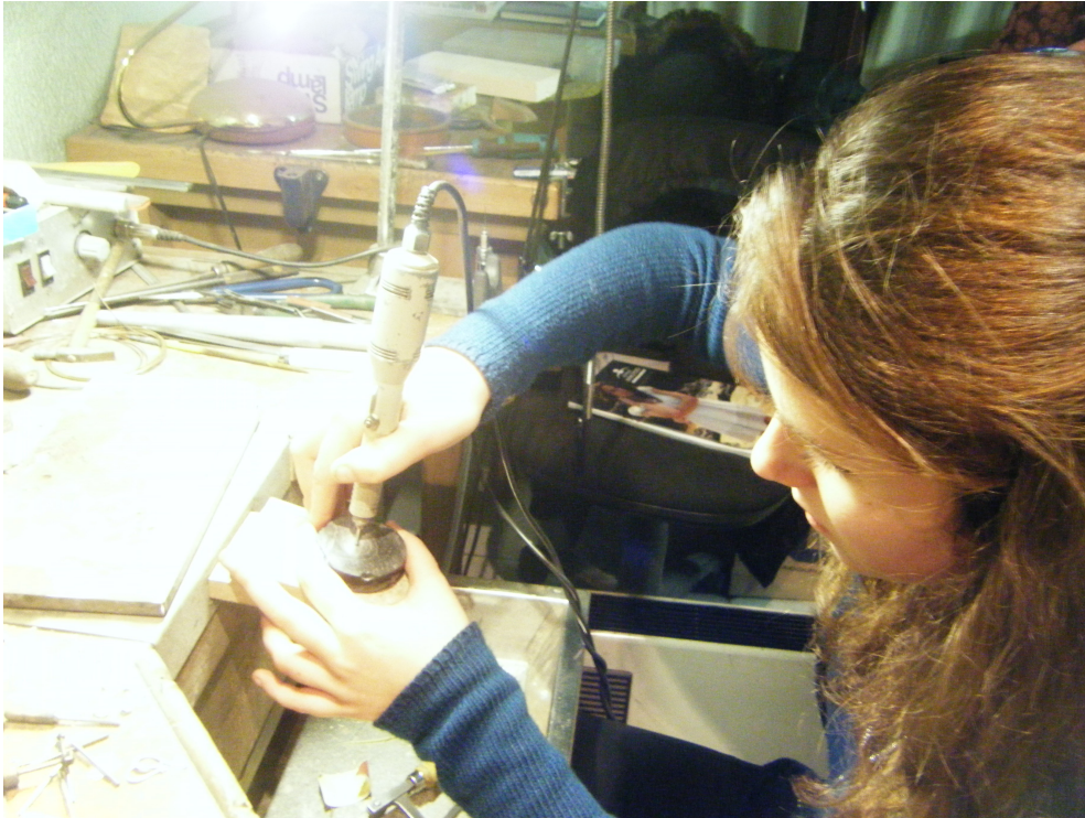
Pas 8: Es fa un forat al centre amb un torn de mà per poder-hi entrar la serra d'arquet de joier.
