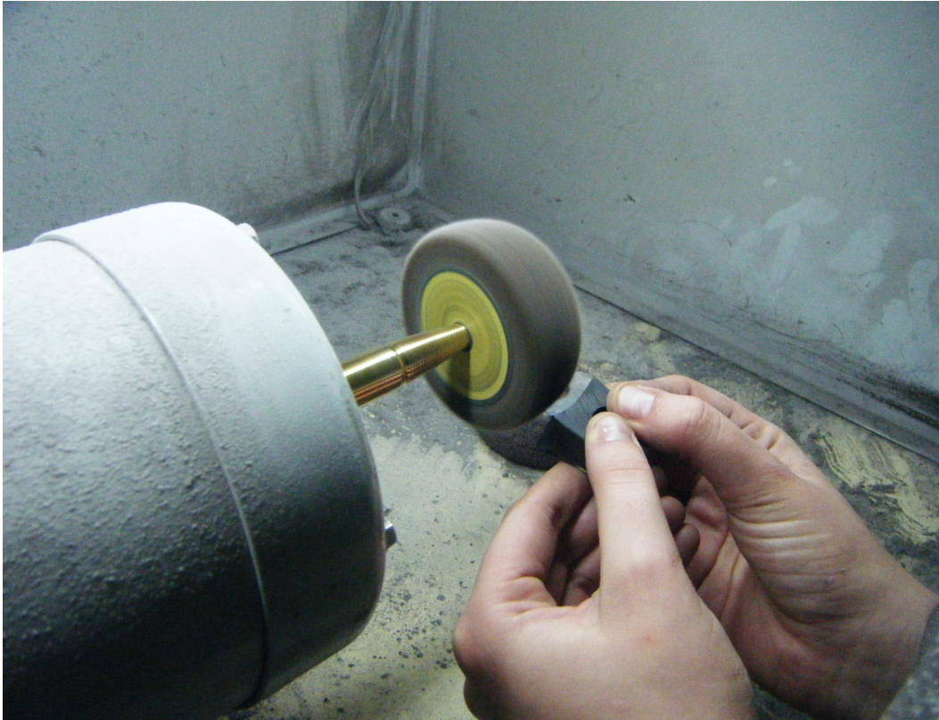
Pas 11: Després poleixo l'anell en una polidora manual utilitzant diversos gruixos d'esmeril perquè quedi més fi i acabar-li de donar la forma definitiva.
