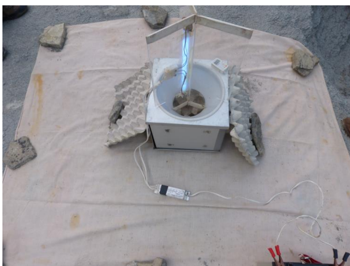
Figura 32. Trampa de llum actínic de 8W alimentat per una bateria de cotxe.
