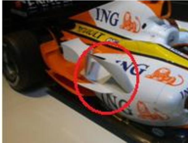
Imatge 2.6: Winglet del Renault de F1 (2008)
