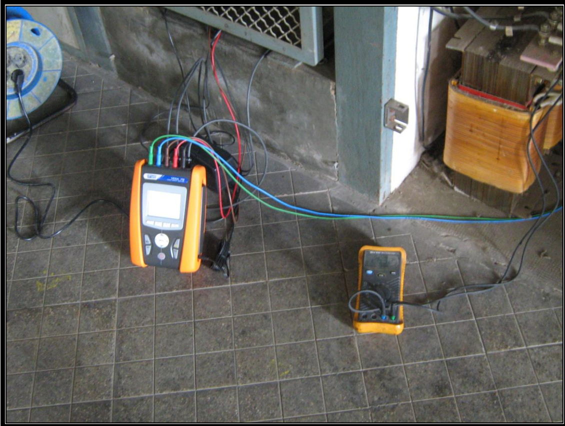
Fotografia del muntatge en conjunt al transformador de la central. A l'esquerra, el panell electrònic. A la dreta, el voltímetre.
