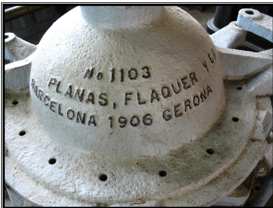
Element de la central (turbina petita que feia de dinamo per la llum de la central) en el que es pot observar el nom del fabricant de les turbines, la data i el lloc de fabricació. (Font: Elaboració pròpia)
