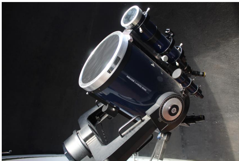
Imatge 15. Telescopi MEADE LX200 EMC amb el filtre solar.
