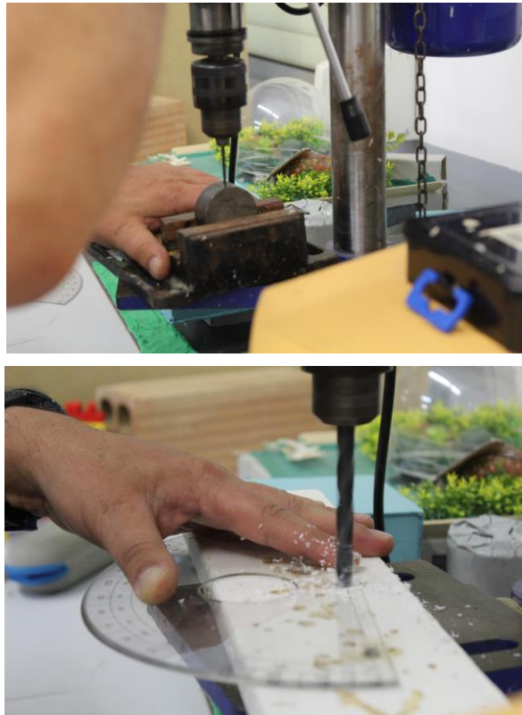
Imatges 34 i 35. Trepant de taula fent un forat del corresponent diàmetre al disc de ferro i al transportador.
