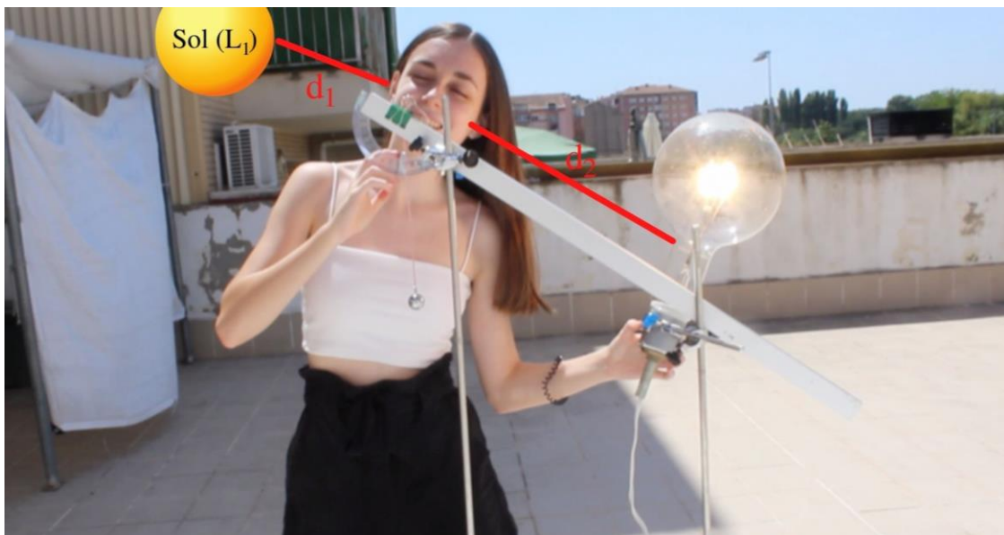
Imatge 45 i 46. Dibuix del muntatge de l'experiment per determinar la lluminositat del Sol a partir d'una bombeta.
