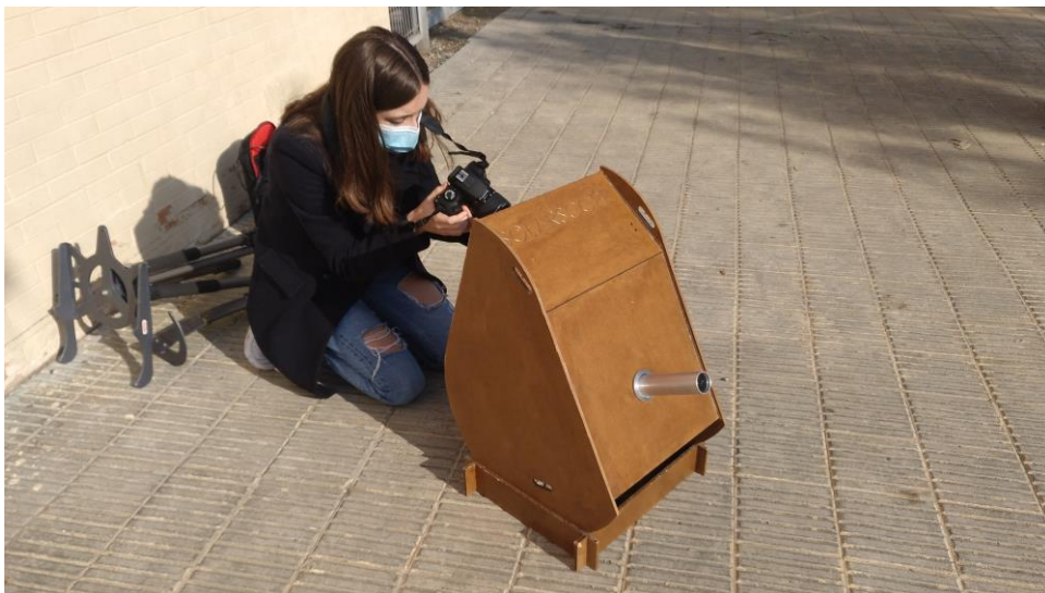
Imatge 17. Observació de la fotosfera solar a través d'un Solarscope.
