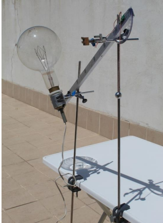
Imatge 47. Estructura per prendre mesures per estimar la lluminositat del Sol.
