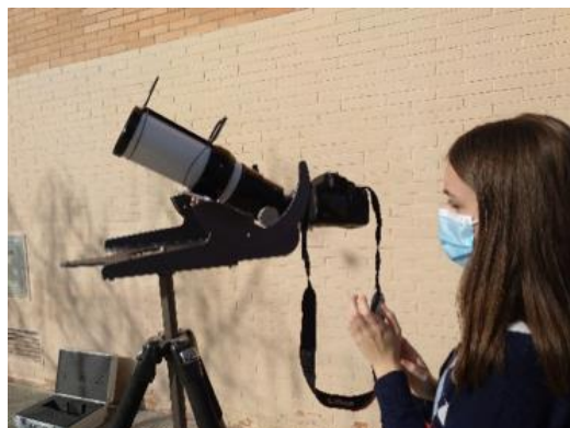
Imatges 53 i 54. Telescopi solar amb filtre H-alfa i càmera acoplada al telescopi solar.
