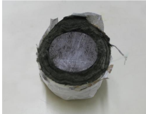
Imatge 37. Disc de ferro aïllat amb làmina mineral de vidre i un cargol pel forat lateral.
