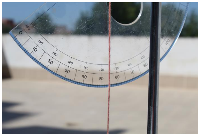
Imatge 38. Pèndul marcant l'altura del Sol sobre l'horitzó en graus.
