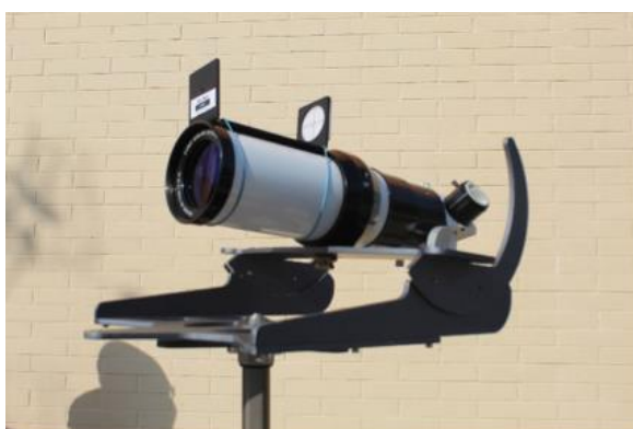
Imatges 53 i 54. Telescopi solar amb filtre H-alfa i càmera acoplada al telescopi solar.
