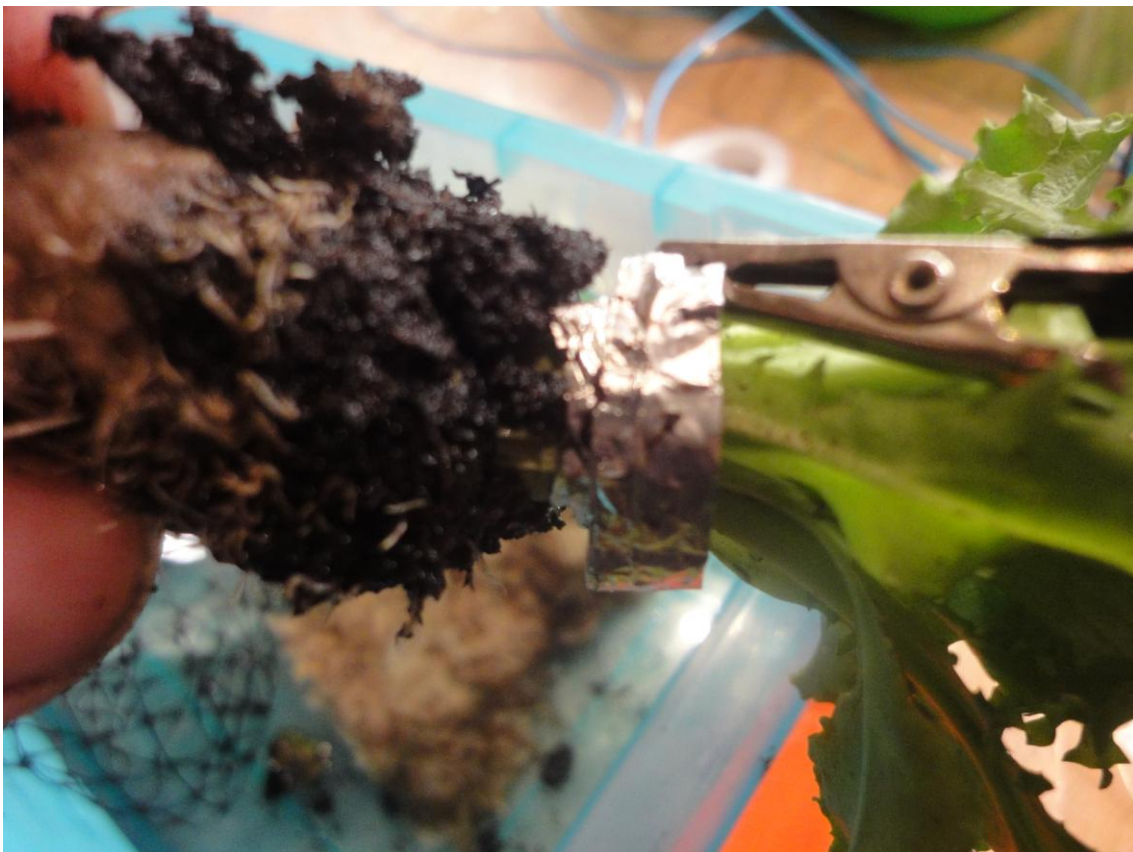
Figura 22: En aquesta imatge es pot observar la connexió entre el cable elèctric, connectat a una pinça de cocodrill, i la tija d'una Cichorium endivia , connectades mitjançant el paper alumini envoltat a la tija. En el cas de la malla de coure la connexió és la mateixa, però la tija està envoltada amb malla de coure.
