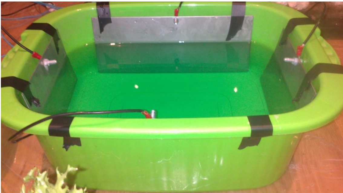
Figura 2: Imatge del recipient amb la solució nutritiva (5M) i les plaques d'acer inoxidable en els seus quatre costats, per proporcionar la circulació de les plantes cap al medi (en aquest cas, ja que en l'altre cas els cables serien blaus), gràcies als FAST-ON incorporats en les plaques que les connecta amb el circuit elèctric.
