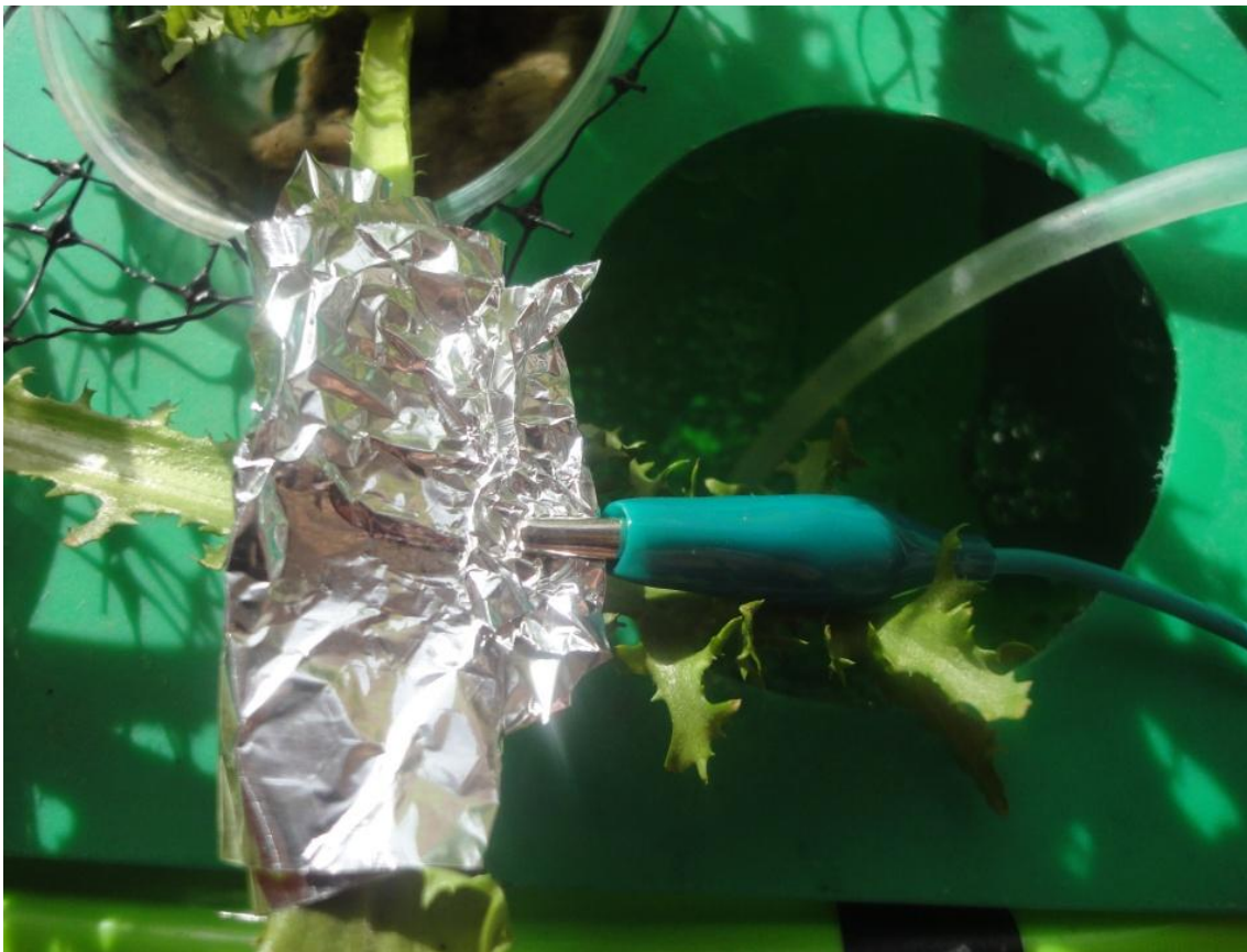
Figura 7: Connexió del circuit amb la planta mitjançant l'emboïllament d'una fulla amb paper d'alumini i el pinçament amb unes pinces de cocodril, connectades (per mitja del cables de la imatge) amb el circuit elèctric.
