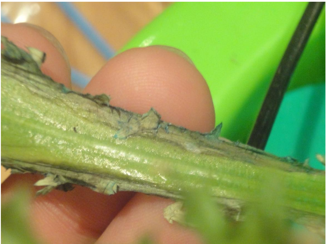
Figura 19: Imatge dels efectes que va provocar el contacte del paper d'alumini connectat a 5,5V de tensió amb la fulla de l'escarola.
