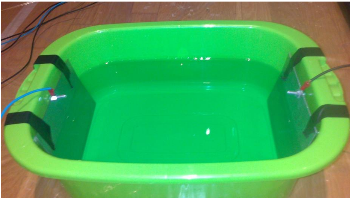
Figura 4: Imatge del recipient amb la solució nutritiva (5M) i les plaques d'acer inoxidable en els seus dos costats, per proporcionar la circulació del corrent, transversalment a les arrels, gràcies als FAST-ON incorporats en les plaques que les connecta amb el circuit elèctric.
