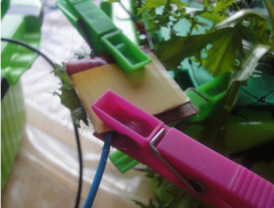
Figura 8: Connexió del circuit amb la planta per mitjà de la connexió d'aquest amb dos materials conductors (llana de ferro) situats a la part inferior i superior d'una de les fulles de la planta.
