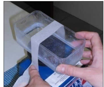
Figura 77. Col·loquem el recipient amb aigua damunt de l'agitador i el lliguem amb esparadrap
