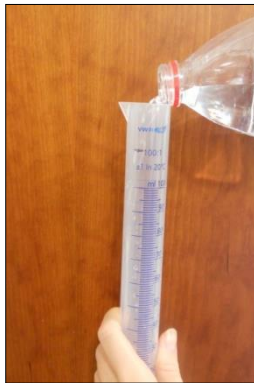
Figura 75. Mesurem 100 ml d'aigua amb l'ajuda d'una proveta
