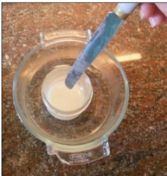
Figura 57. Posem el pot dels filtres al bany maria i anem remenant fins que ens quedi transparent Font: Imatge pròpia
