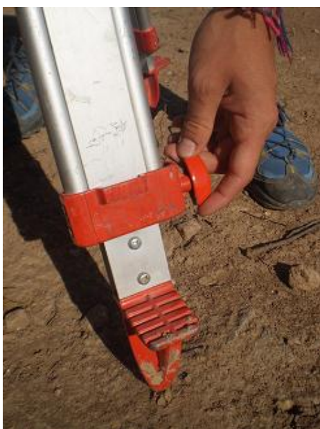
Extrem de la pota del trípod del nivell. Es pot observar que hi ha una clau de pas per a fixar les potes i que aquestes estan acabades en punta per a poder clavar-les a terra
