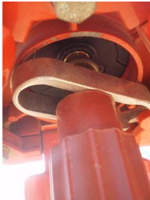
Detall del cargol del fixació del tripode al nivell
