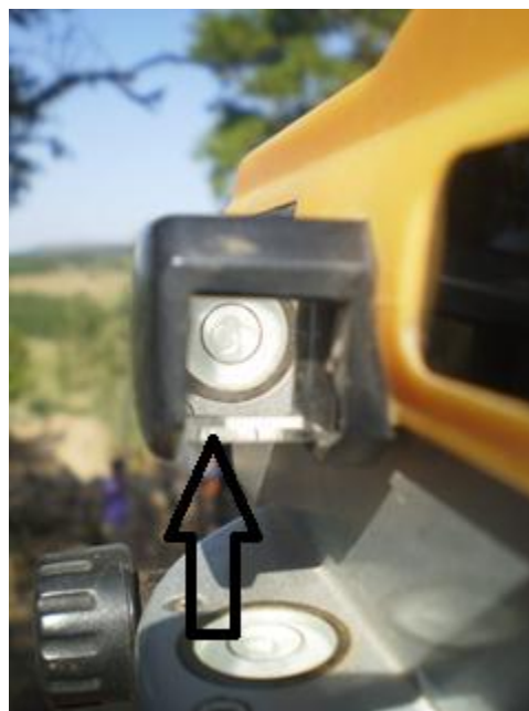
Nivell convencional de nivell (marcat amb una fletxa) utilitzat a l'excavació concertada de Solsona
