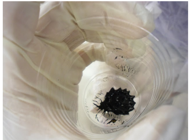
Figura 9. Ferrofluid al qual hem acostat un imant.
