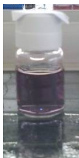
Figura 6. Nanopartícules d'or de 117nm de diàmetre.
