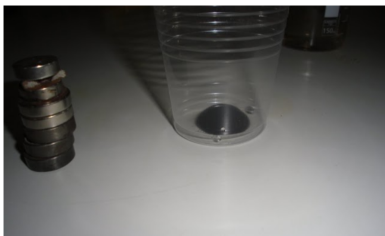
Figura 7. Ferrofluid de magnetita.
