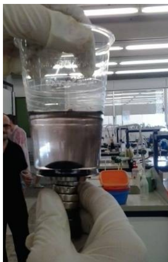
Figura 5. Atraient el ferrofluid cap al fons del got mitjançant un imant.
