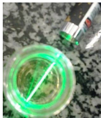
Figura 2. Dispersió d'un feix de llum làser per part de nanopartícules de plata.
