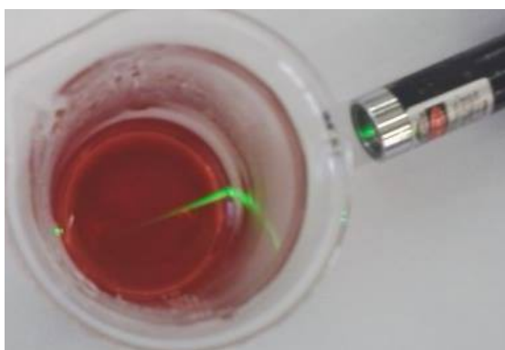
Figura 1. Dispersió d'un feix de llum làser per part de nanopartícules d'or.
