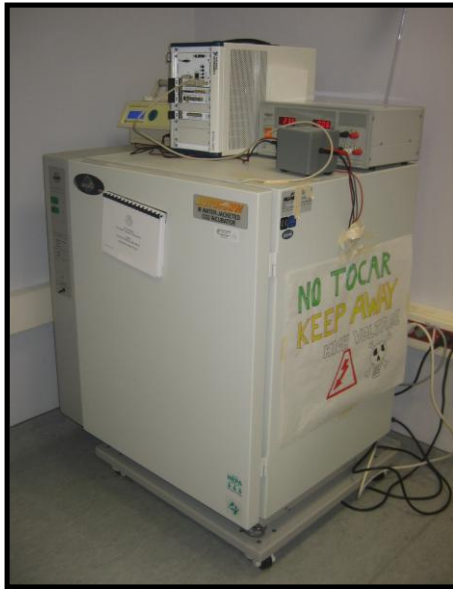
FIGURA 72: Incubador que manté les cèl·lules a 37°C de temperatura per tal de que la seva proliferació sigui més eficaç.
