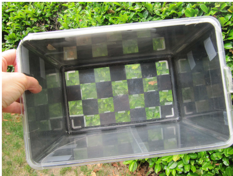
Fig. 6.2. Capsa de plàstic transparent amb les parets folrades amb cartolina negra i la base amb 14 quadrats negres.
