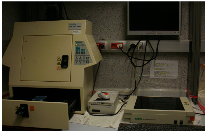
Figura 5': Màquina emissora de raigs UV per a la realització de fotografies de mostres fluorescents
