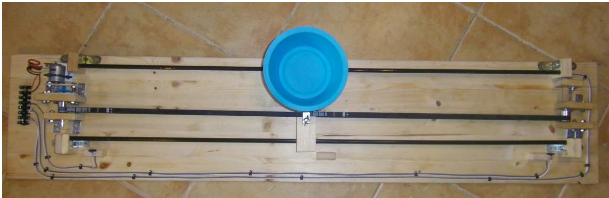
Imatge de tot el recolridor cablejat, sense port de connexió
