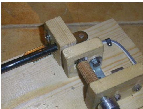
Imatge de l'encoder muntat, unit amb l'eix i connectat elèctricament
