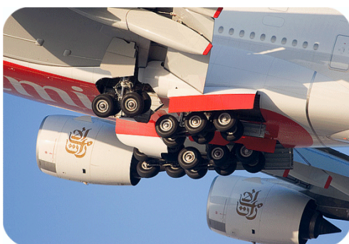
Tren d'aterratge d'un Airbus A380
