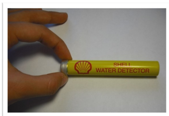
Tubet que conté les pastilles identificadores de la presència d'aigua als tancs de combustible
