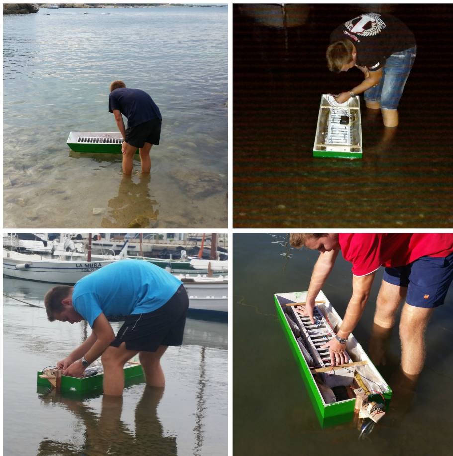
Il·lustració 20: Diverses proves que es van dur a terme un cop el prototip es va finalitzar. A la imatge situada a la part inferior dreta es pot apreciar el prototip totalment finalitzat, observi's la nova mànega, les bosses plenes de ferro i l'hèlice, entre d'altres.
