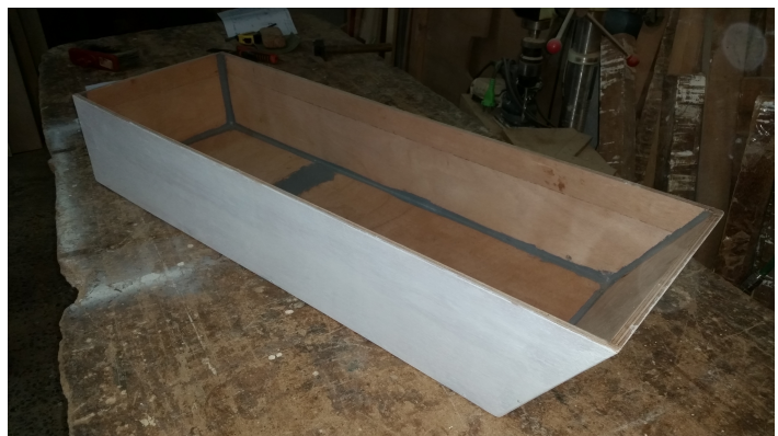
Il·lustració 17: Estructura del vaixell segellada.
