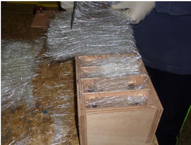
Il·lustració 13: Col·locació de la fibra de vidre.
