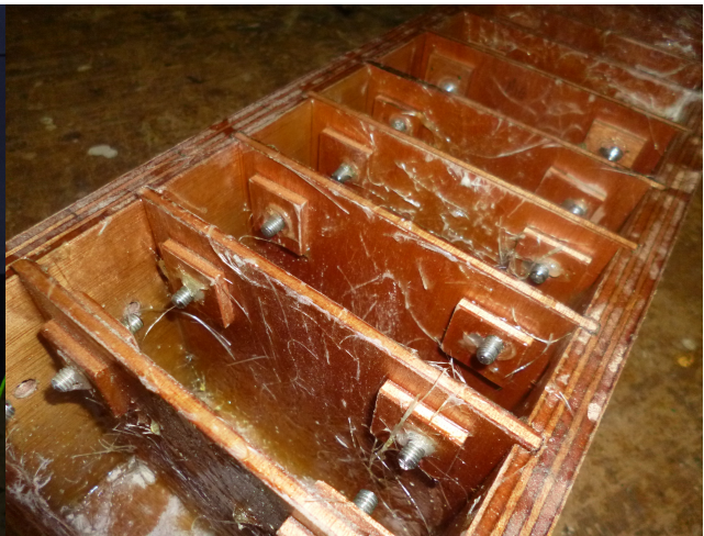
Il·lustració 14: Fixació de la fibra de vidre.
