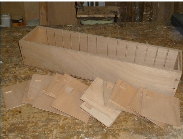
Il·lustració 10: Caixa on es construirà la cel·la i separadors de fusta.
