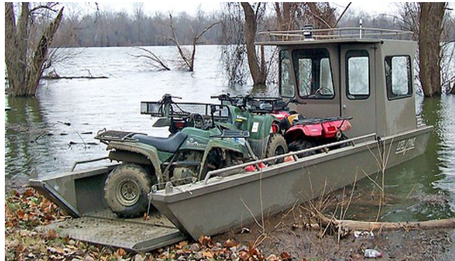
Il·lustració 8: Petit bot de desembarcament fet a base d'alumini.
