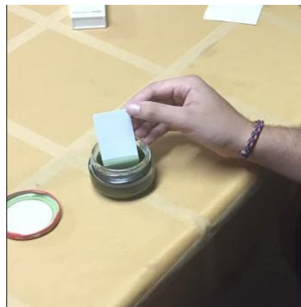
fig.25 Aplicació d'una de les plaques de silicagel a una de les mostres estudiades.
